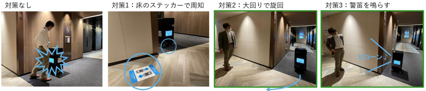
図：曲がり角における人とロボットの衝突を避ける実証実験の例 複数の対策を比較し、「警笛」や「大回り」の有効性が高いことを確認
