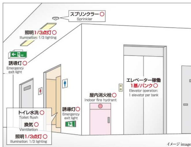
ビル共用部の停電時電力供給
