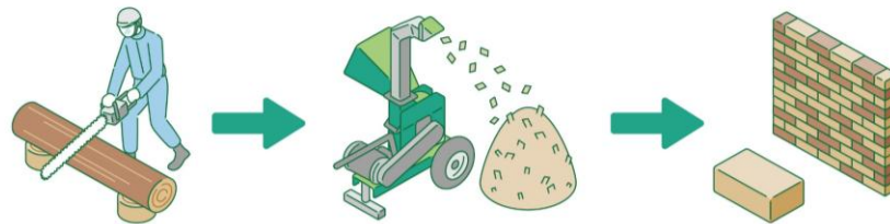
間伐材から外構ブロックを生成
